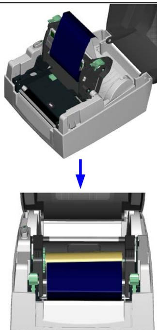
6. 待碳带固定好后，旋转碳带回收轮将碳带往机体方向卷入并拉平。
